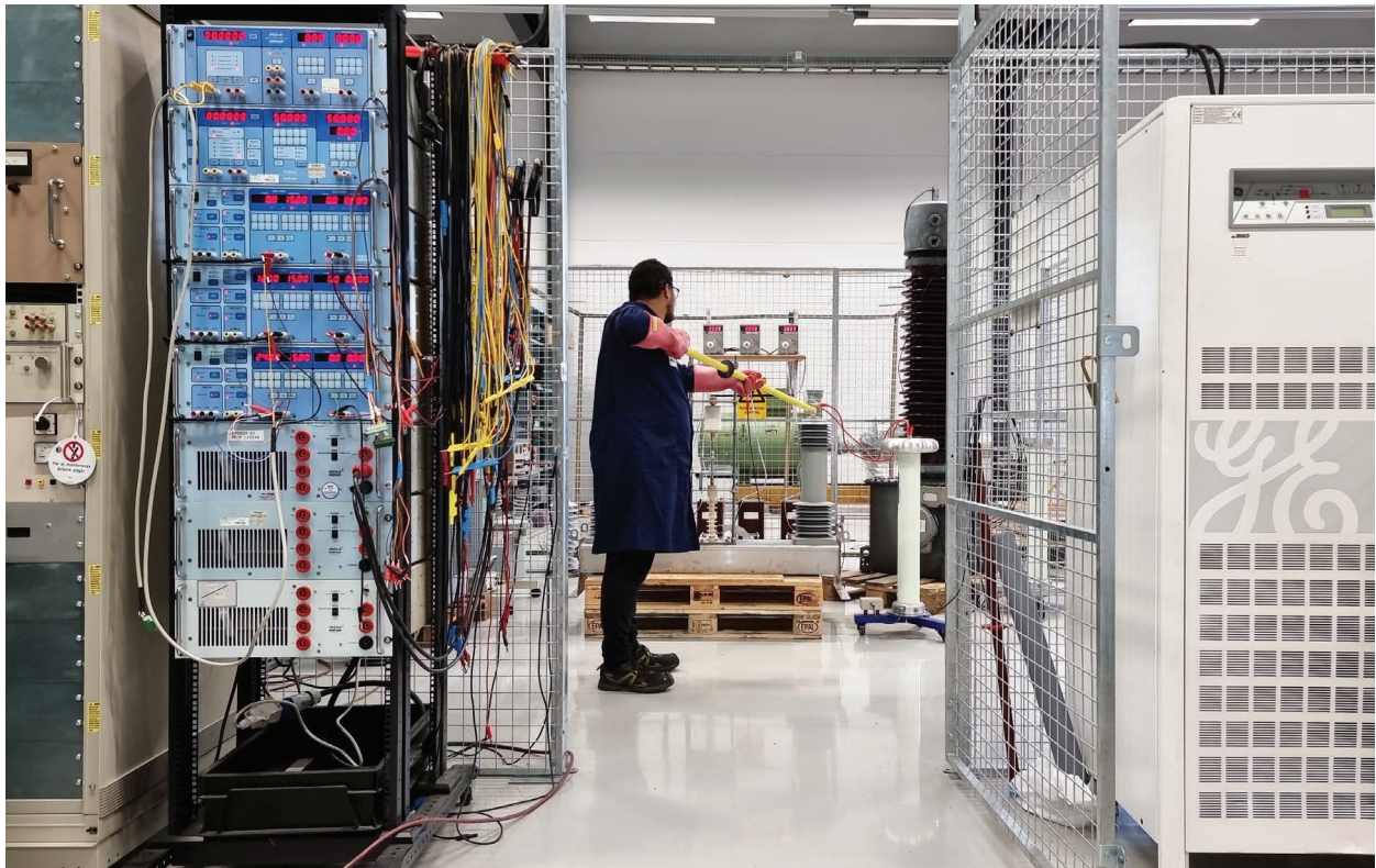
Provning av strömbrytare i elektrisk mellanspänningstestcell
