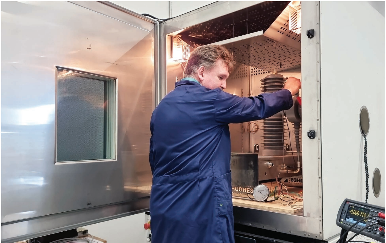
Temperaturtestning av en vakuumbrytare i klimatkammaren, - 80°C till + 180°C
