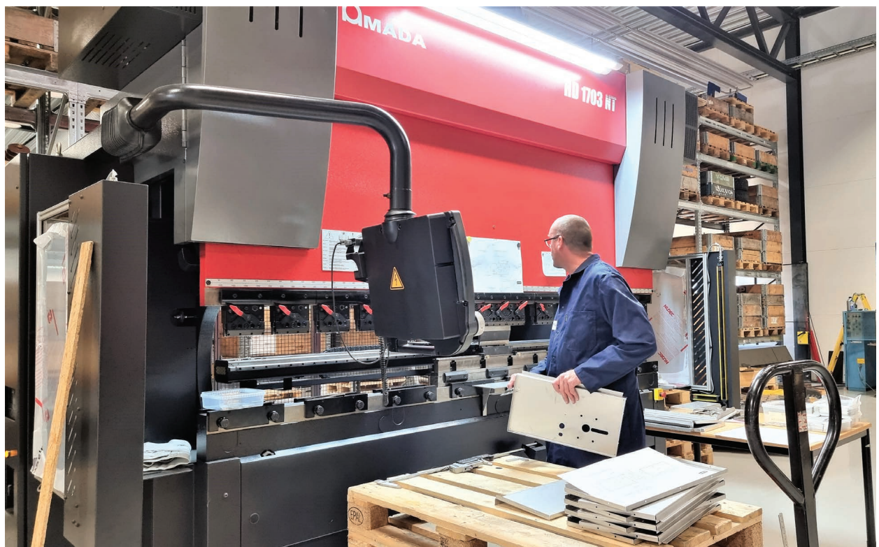
8 axlar 170t automatisk kantpress för bearbetning av plåt detaljer
